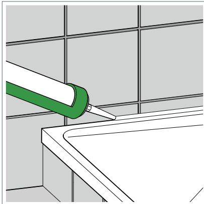
Ilustr. 105: Uszczelnianie brodzika
