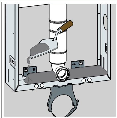
Ilustr. 50: Podłoże bloku WC wypełnić zaprawą.
