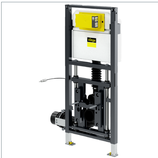
Ilustr. 145: Stelaż WC Prevista Dry, wysokość ceramiki indywidualnie regulowana przez użytkownika za pomocą przycisku (wzór 8521.32)
