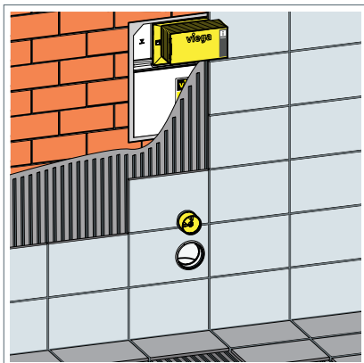
Ilustr. 53: Pełny montaż spluczki Prevista Pure wzór 8502 w połączeniu z WC stojącym
